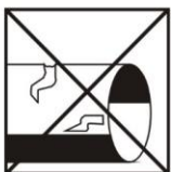
不可使用有裂缝或破损的管子管件
